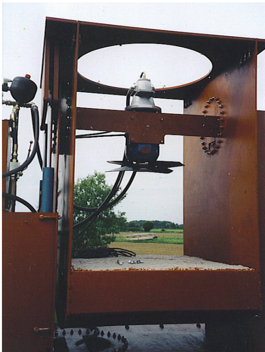
Bild 5. Pendel, generator, fläkt och hydraulik.
